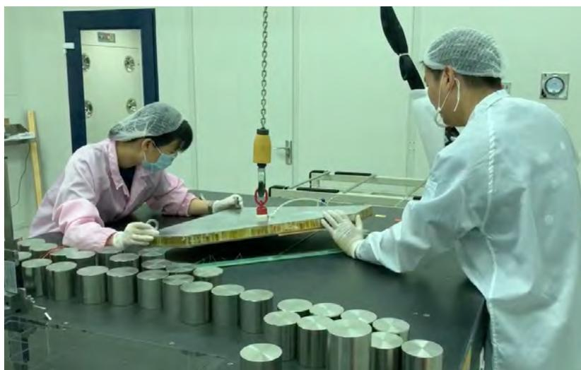
图 4.22: 单元室的合成。在单元室组装过程中，首先将用于合成的 PCB 板通过真空吸附的方式固定在大理石平台上，以确保其平整度。在组装期间，将重约  $11\text{g}/\text{cm}^2$  的铁块放置在腔室顶部，使得腔室整体受到约  $34\text{kg}$  的压力，这一过程至少持续 18 小时。在合成过程中，还会向腔室内充入二氧化碳气体，持续 6 小时，其目的是将室内由胶水挥发出来的水分子带出
