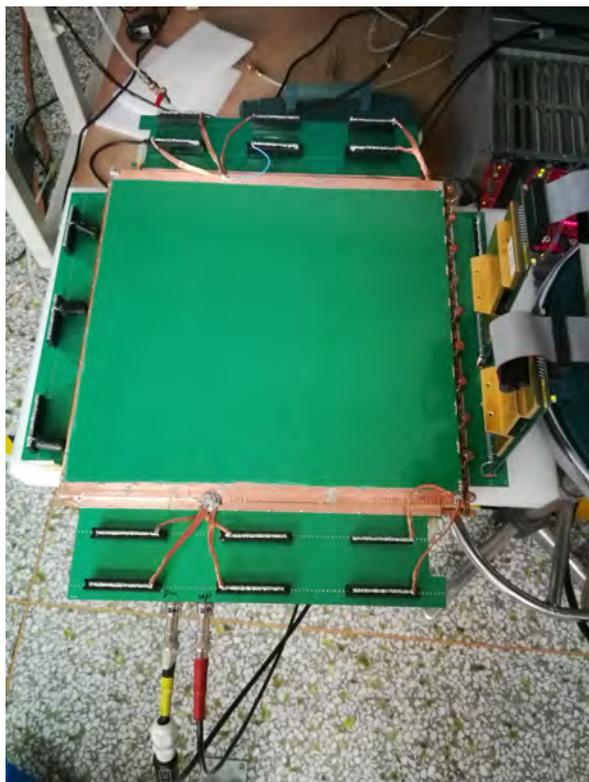
图 4.2: 30cm×30cm sTGC 样机使用 STAR TPX 电子学进行通道噪音测试
