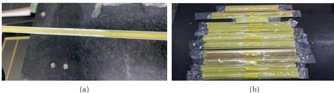
图 4.28: (a) 图中反光涂层是涂完绝缘清漆 Luka 后的效果，L 槽为中间凸起部分与两侧平面相连接的 L 表面；(b) 是涂抹 Luka 后密封保存的支撑条和边框
