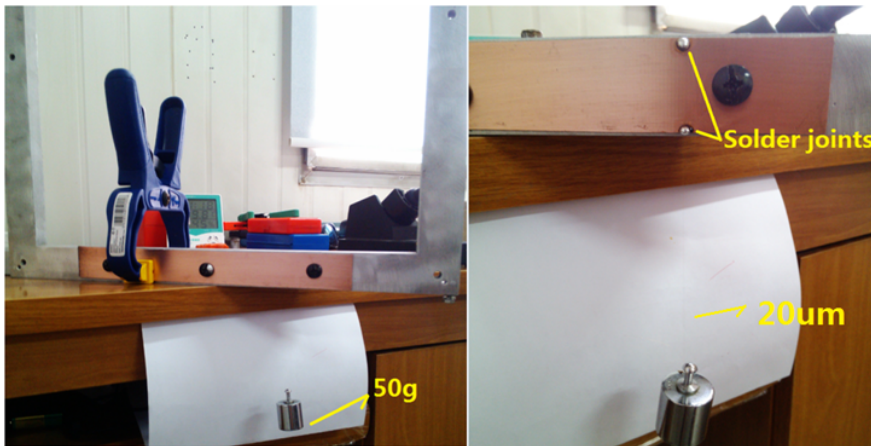
图 2.15: 利用标准重量砝码来拉制特定张力的丝。
