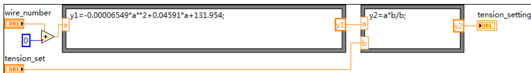
图 2.12: LabVIEW张力实时调节模块
